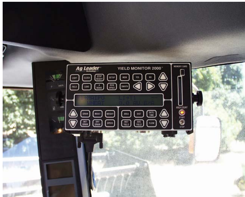
Foto 1. Monitor de rendimiento de grano Ag Leader Modelo 2000 instalado en el interior de la cabina de una combinada CASE 2166 Axial Flow.
