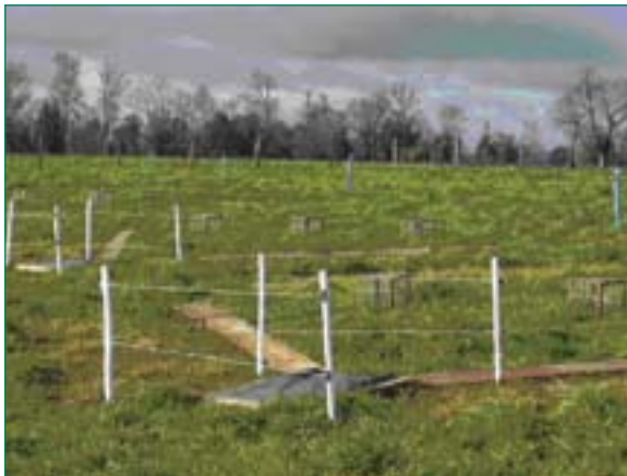
Vista parcial de la implementación de la metodología de lisímetros superficiales en terreno (Izquierda) y de la ubicación de las cápsulas cerámicas durante el pastoreo (Derecha).
