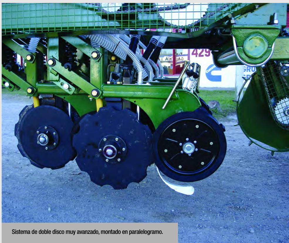
Sistema de doble disco muy avanzado, montado en paralelogramo.
