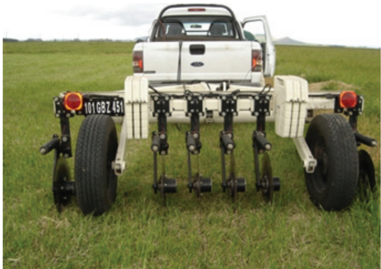
» Fig. 7. Equipo Veris 3100 montado sobre una camioneta, realizando el relevamiento de CEa en una pastura de festuca en un lote de aptitud ganadera.
