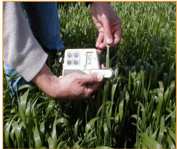
Figura 1. Clorofilómetro SPAD
