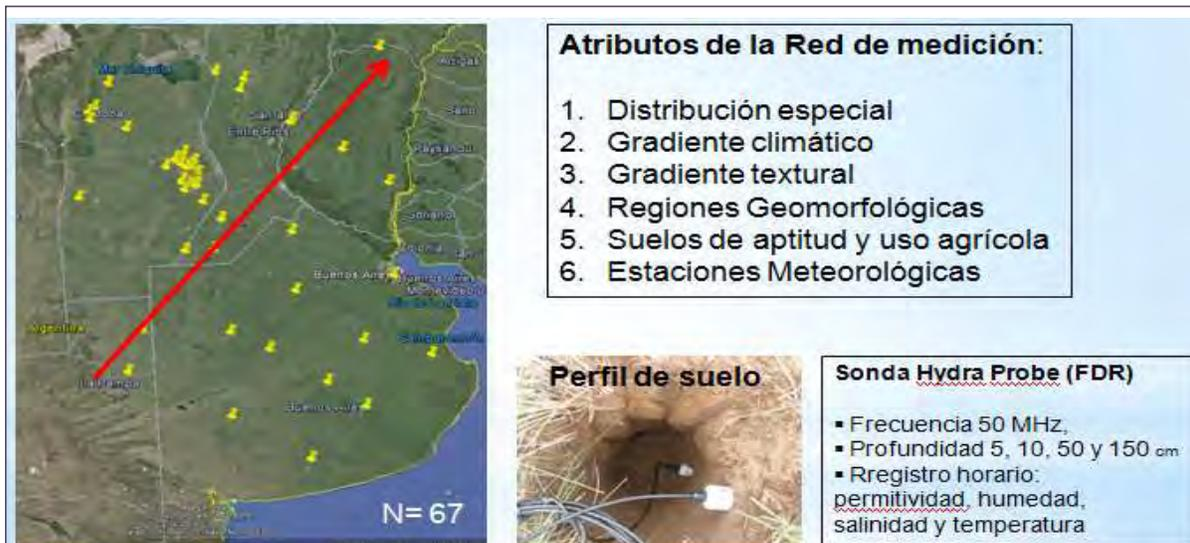
**Figura 5.** Ubicación geográfica de la red de monitoreo de la permitividad del suelo y características de la sonda Hydra Probe.
