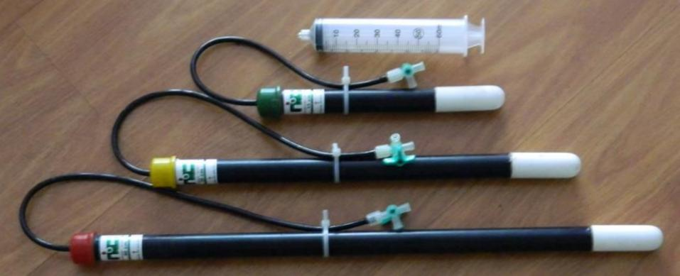
Extratores de Solução do Solo por sucção a vácuo
