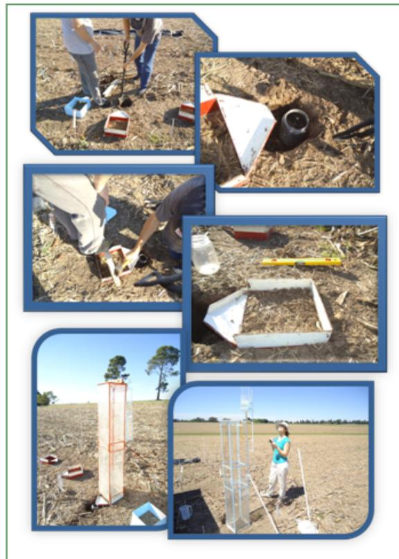
Figura 6. Secuencia de instalación de simulador de lluvia y medición.
