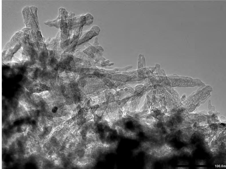
**Figura 2.** Caracterización de las nanopartículas de fósforo en microscopio electrónico de barrido.
