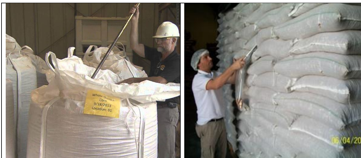
Figura 2. Técnica de muestreo de Big Bags y bolsas 50 kg (ésta debe estar horizontal)
